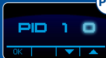
PID on/off 100% autokonsumpcja równomierne obciążenie pracy faz
