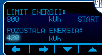
Licznik pracy kotła
