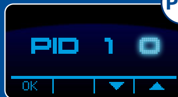
PID on/off 100% autokonsumpcja równomierne obciążenie pracy faz
