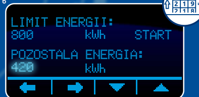
Licznik pracy kotła
