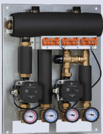
SZWADRON 370 (SKE 2DC+ 35 kW, UNI, zawór mieszający termostatyczny, pompy DN15) kod towaru 835370
