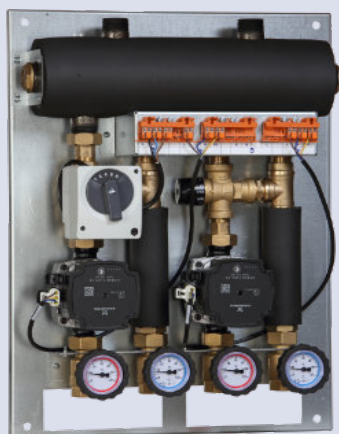
SZWADRON 384 (SKE 2DC+ 35 kW, zawór mieszający termostatyczny, z. obrotowy z siłownikiem, pompy DN15) kod towaru 835384
